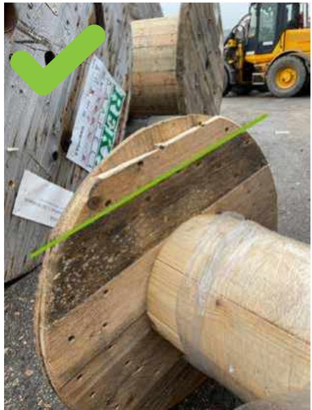
Korjattavissa, laudat voidaan vaihtaa.
