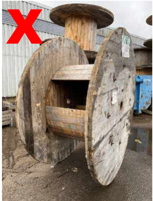
4. RL Rumpulautoja puuttuu
