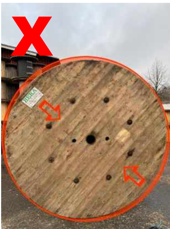
3. LV Laippa vääntynyt ja rumpu mahdollisesti soikea. Soikeus testataan asfaltilla rullamalla.
